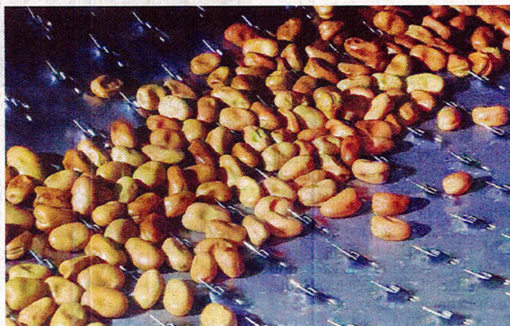
Blick ins Innere eines Erbsentrieurs: Von Schädlingen befallene Früchte werden von den Nadeln aufgespießt.
